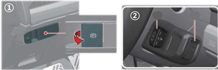
① Calce las ruedas y accione el interruptor del freno de estacionamiento eléctrico para aplicar el freno.
