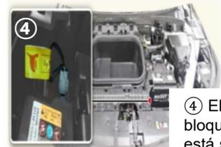
④ El conector de bloqueo de servicio está situado en el lado izquierdo de la batería.
