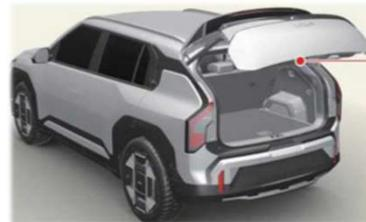
Retire la cubierta de la parte inferior del portón trasero y deslice a continuación el pestillo en la dirección de la flecha para desbloquear el portón.
