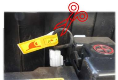
Corte el cable del conector de bloqueo de servicio para desactivar el sistema de AV.
