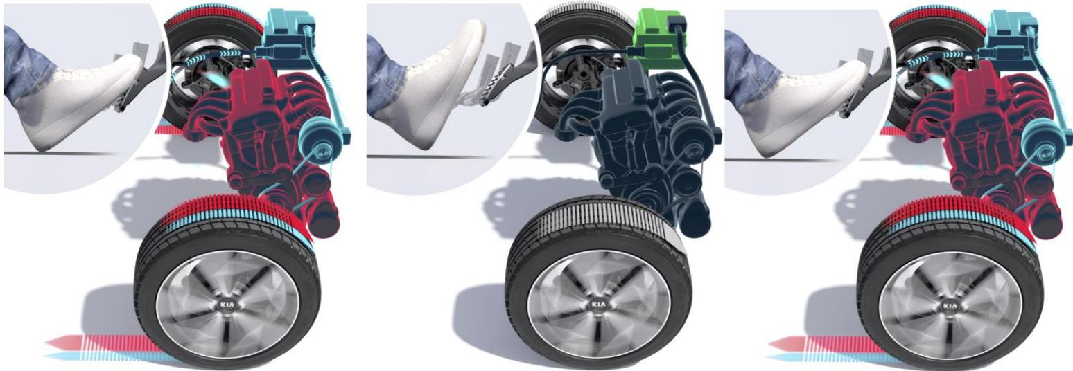
El sistema **MHEV** asiste al motor de combustión con empuje eléctrico cuando es necesario, para descargarle de esfuerzos, conseguir menor consumo y menores emisiones de gases contaminantes. El sistema se recarga con velocidades de crucero y en retenciones. Igualmente, apaga el motor de combustión en detenciones para ahorrar combustible y evitar emisiones de gases contaminantes innecesarios, estando preparado para arrancar inmediatamente cuando se reanude la marcha.
