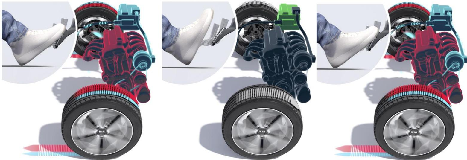
El sistema **MHEV** asiste al motor de combustión con empuje cuando es necesario, para descargarle de esfuerzos, conseguir menor consumo y menores emisiones de gases contaminantes. El sistema se recarga con velocidades de crucero y en bajadas. Igualmente, apaga el motor de combustión en detenciones para ahorrar combustible y evitar emisiones de gases contaminantes innecesarios, estando preparado para arrancar inmediatamente cuando se reanuda la marcha.
