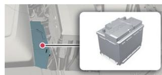
Batería en el compartimento del motor
