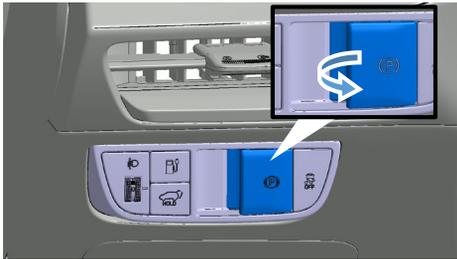
1. Calce las ruedas y accione el interruptor para aplicar el freno de estacionamiento.
