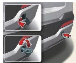
El gancho de remolque se encuentra en el portaherramientas situado en la puerta trasera
