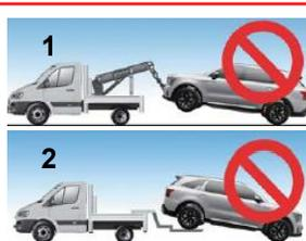
Nota: No efectúe el remolque con accesorios de eslingado (1). No remolque el vehículo con las ruedas delanteras apoyadas en el suelo, ya que eso podría causar daños al vehículo (2).
