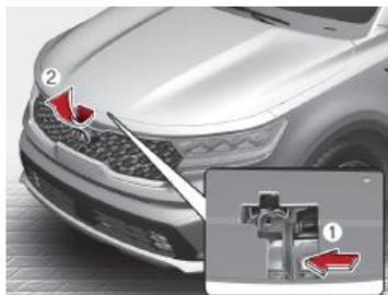
2. Eleve el capó levemente, presione el pestillo auxiliar (①) del área central hacia arriba y levante el capó (②)
