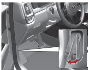
1. Tire de la palanca de apertura para desbloquear el capó. El capó deberá abrirse saltando ligeramente.
