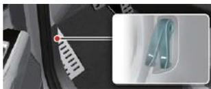
Tire de la palanca de apertura para desbloquear el capó.
