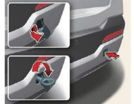
El gancho de remolque se encuentra en el portaherramientas situado en la puerta trasera
