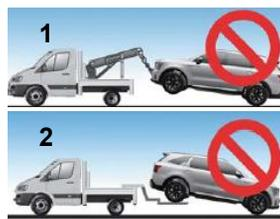
Nota: No efectúe el remolque con accesorios de estingado (1). No remolque el vehículo con las ruedas delanteras apoyadas en el suelo, ya que eso podría causar daños al vehículo (2).
