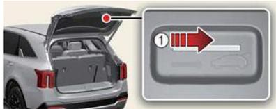
2. Deslice el pestillo en la dirección de la flecha ① para desbloquear la puerta trasera.
