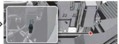
En caso de emergencia, corte el cable de la clavija de bloqueo de servicio para aislar el alto voltaje de la batería.
