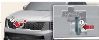
Presione la palanca de apertura auxiliar del capó (1) hacia la izquierda y levante el capó (2).
