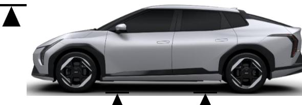
Para estabilizar el vehículo, coloque bloques de madera u objetos similares justo debajo de los pilares delantero y trasero en los cuatro puntos indicados.
