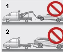
Nota: no efectúe el remolque con accesorios de eslingado (1). No remolque el vehículo con las ruedas delanteras apoyadas en el suelo, ya que eso podría causar daños al vehículo (2).
