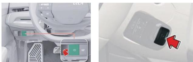
① Calce las ruedas y aplique el freno de estacionamiento eléctrico accionando el interruptor.
