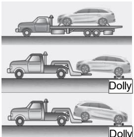
Nota: se recomienda el uso de plataformas rodantes o de una plataforma de cama baja. Utilice un elevador de ruedas o equipamiento de cama baja.
