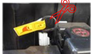
Corte el cable del conector de bloqueo de servicio para desactivar el sistema de AV.
