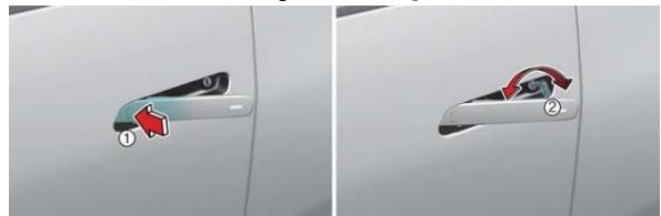
Presione la parte frontal de la manija de la puerta para extraer la parte trasera, utilice la llave para desbloquear el cierre y saque la manija para abrir la puerta.
