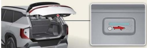
1. Inserte una herramienta larga y plana, como un destornillador, en la abertura de la parte inferior del portón trasero.
